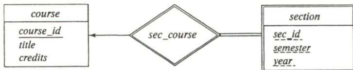
图 6-14 具有弱实体集的 E-R 图
